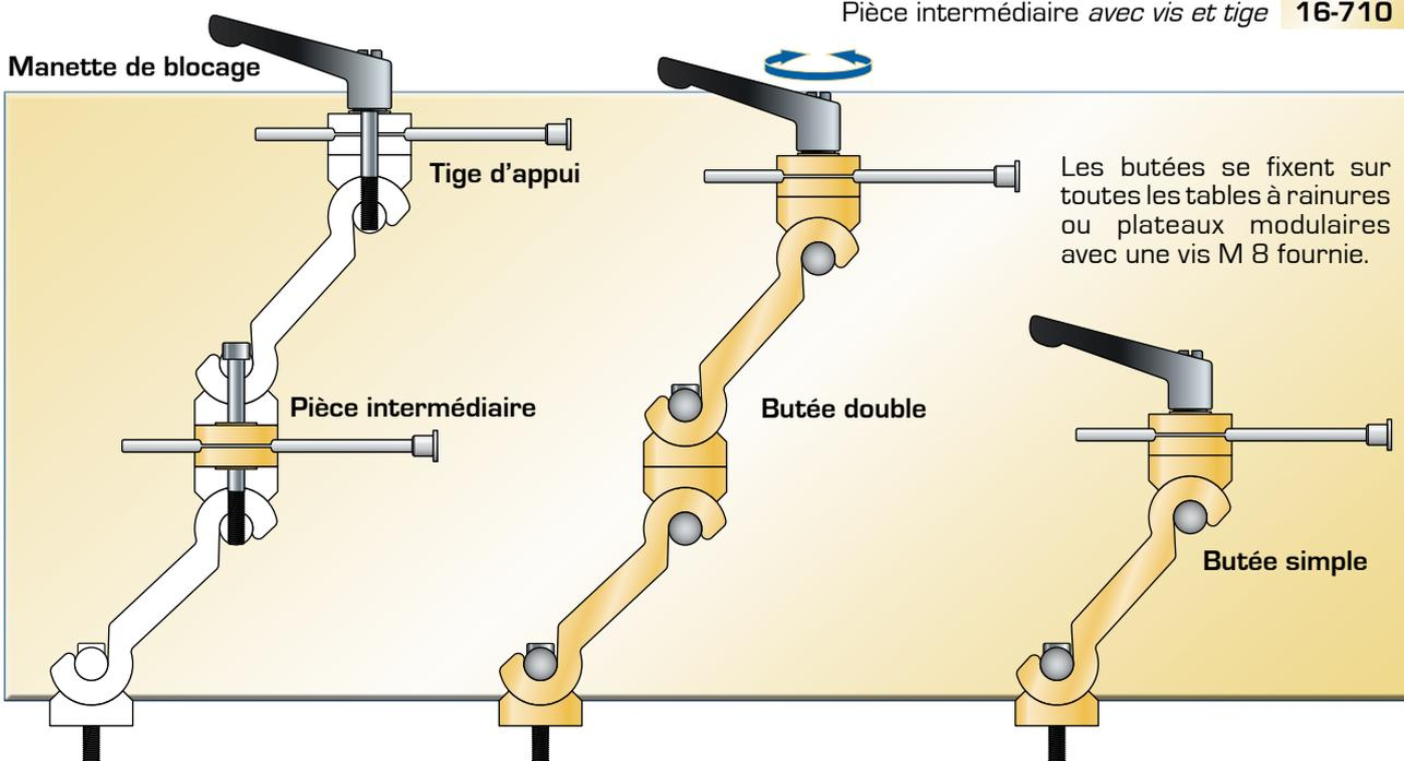
Butée en aluminium anodisé, tige en acier traité, levier de verouillage orientable.
